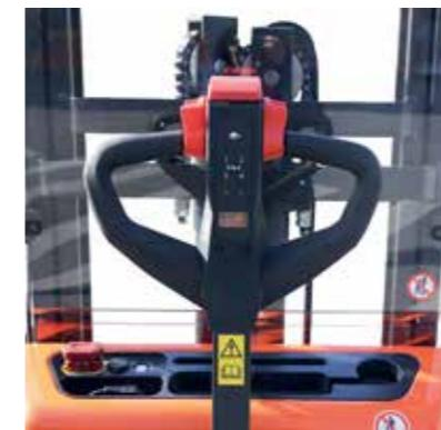
S kapacitetom od 1300 kg, elektro visoko podizni viličar s dvostupanjskim kranom dostupan je u 4 visine dizanja do max. 3600 mm. Jedna od velikih prednosti ovog viličara je što je opremljen kranom sa slobodnim hodom vilica, što mu omogućuje rad u niskim prostorima
