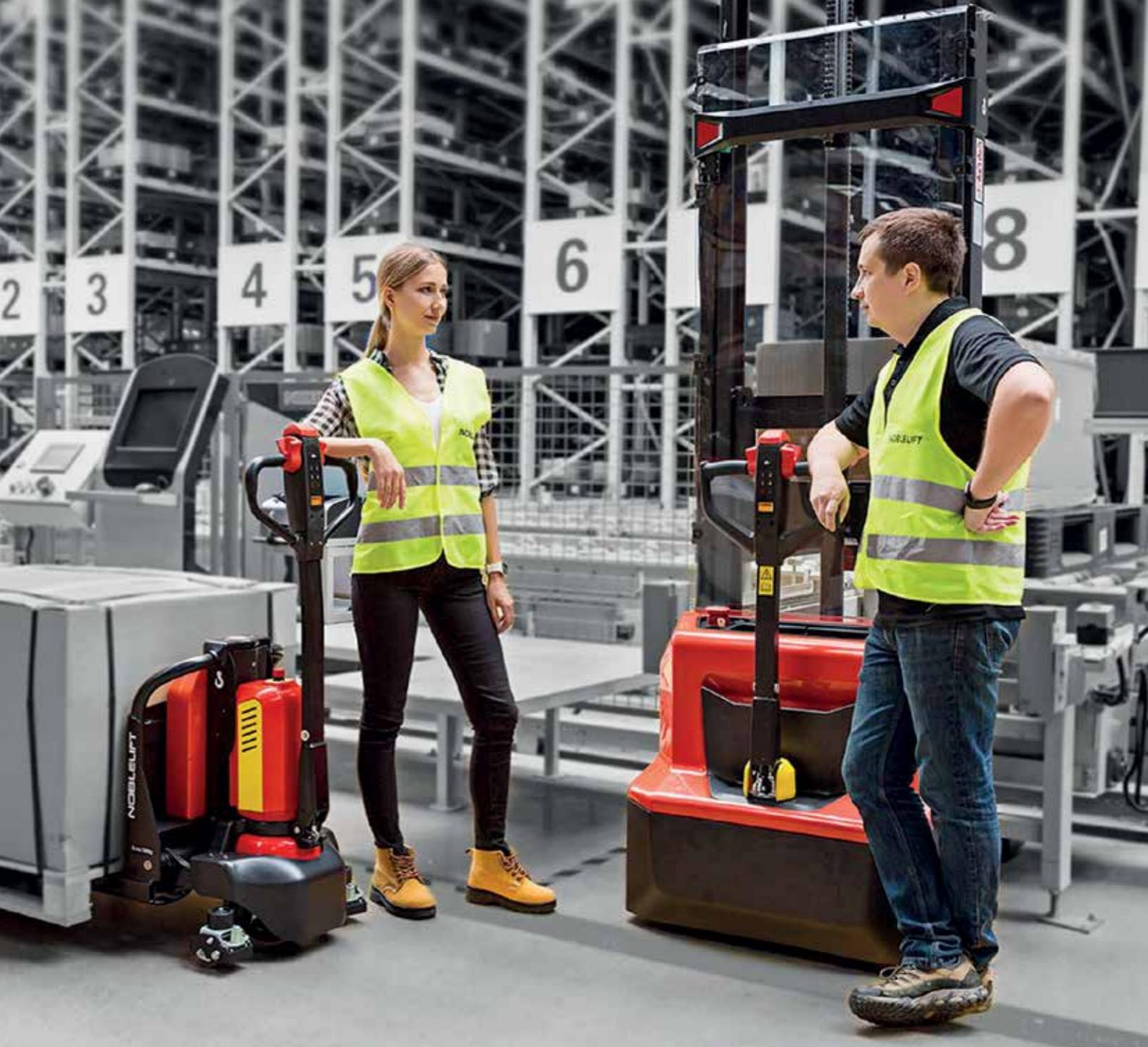
Robustna šasija s jakim oklopom debljine 8 mm štiti viličar i njegove komponente od mehaničkih udaraca iz okoline. U kombinaciji s metalnim poklopcom baterije, viličar je dobro opremljen za smanjenje održavanja i oštećenja na minimum. Prljavi podovi imaju manji utjecaj na vertikalni AC motor jer su komponente i kočnice izvan dosega izravnih udaraca. Kontroler s IP 54 zaštitom, siguran od prašine i prskanja vode.
