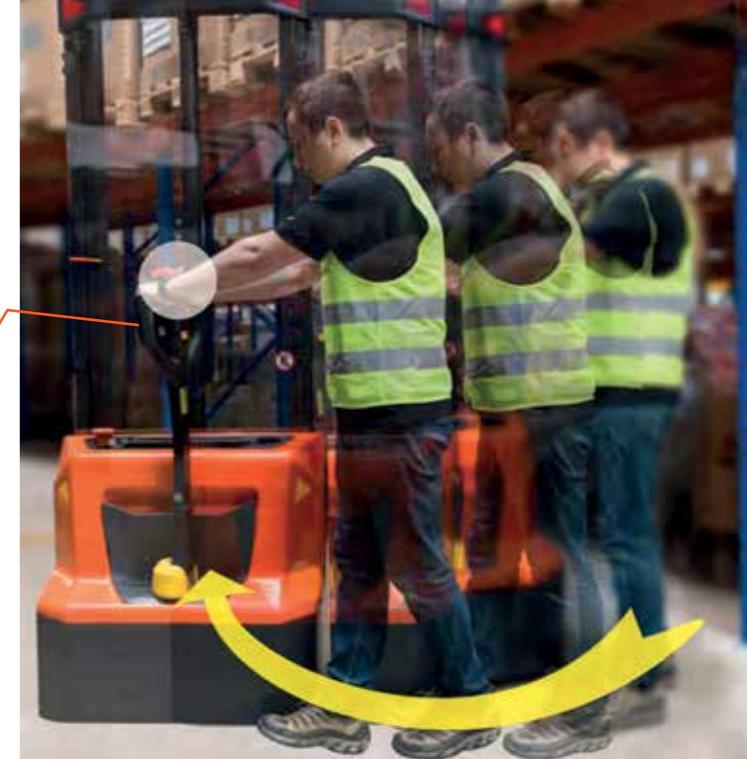
Upravljačka ruda podržana je zračnom oprugom koja pomaže vratiti upravljač u vertikalni položaj bez udarca na krajnjoj točki.
