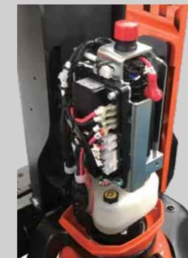
Ne koriste se crjeva ili cijevi u hidrauličkom sustavu podizanja, što značajno poboljšava pouzdanost i smanjuje broj potencijalnih problema vezanih uz curenje kroz spojnice ili njihove brtve
