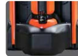
Čvrsta čelična oplata štiti stopala operatera tijekom rada i osigurava komponente viličara od sudara s objektima.
